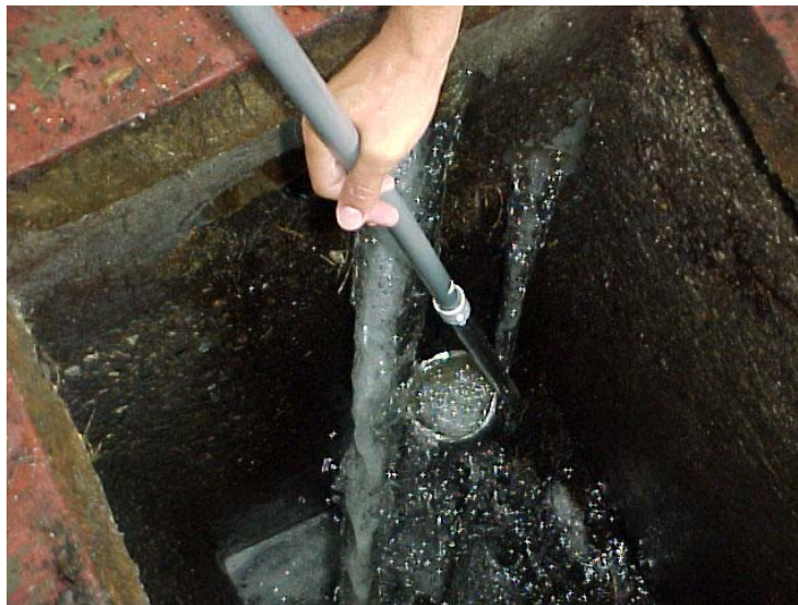
Se muestra el método utilizado para recoger la muestra de agua residual tratada (1 er muestreo)
