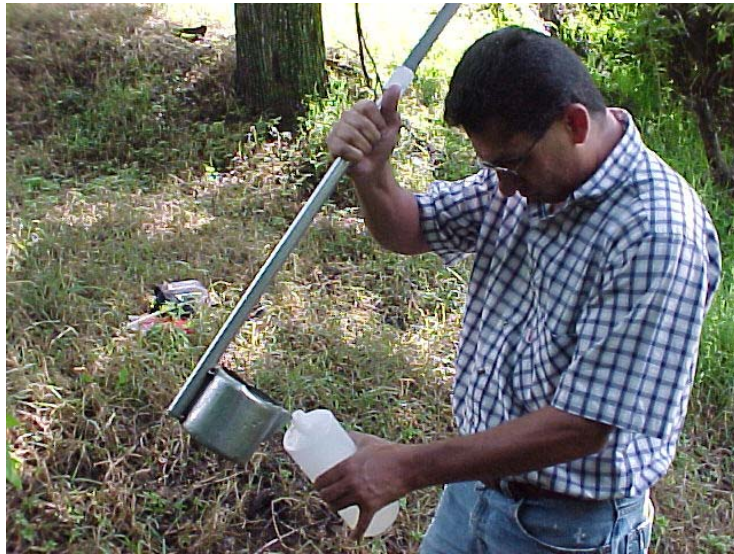
Muestreo compuesto de 6 horas. El volumen de la muestra individual fue de 500 ml
