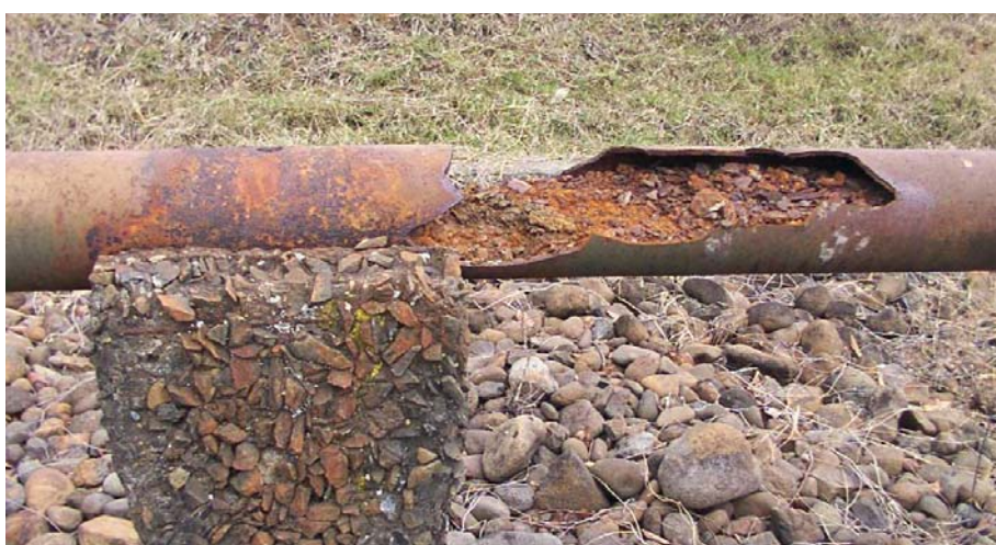
Tubería de hierro obstruida por sedimentos
