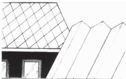
**2. Fibrocemento:** como su nombre lo indica, este es un material hecho a base de una mezcla de cemento que se comprime para formar láminas de diversos tamaños y formas. Generalmente lo encontrará en forma de teja o en láminas onduladas. Es del mismo material del FIBROLIT o PANELEX (y otras marcas) pero de menor grosor. Además se incluye aquí el denominado asbesto-cemento. (Ricalit)
