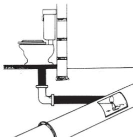
**2. Conectado a tanque séptico:** el servicio sanitario se comunica con un tanque de concreto o cemento armado, conectado a áreas de drenaje. Por lo general, está construido en el patio de la casa. Si el tanque se encuentra conectado a la alcantarilla pública, marque la opción anterior: "alcantarilla o cloaca".
