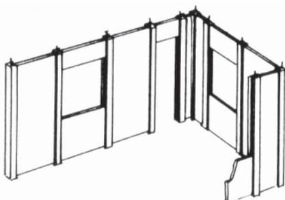
**4. Prefabricado:** corresponde a las baldosas de concreto que se adquieren ya fabricadas y que juntas conforman las paredes. Son sostenidas por postes o columnas que tienen un canal donde se insertan las baldosas. Las verticales se colocan una junto a la otra y forman paredes más delgadas que las de block.
